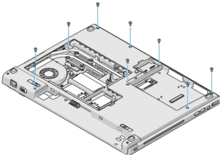
□□□ コンピュータを裏返し、パームレスト上部を固定している 8 本の M2.5 x 5 mm ネジを外します。パームレスト上の「P」記号を参考に、ネジの場所を探します。
